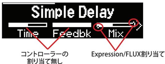
これで、接続したエクスプレッション・ペダルとFLUXフットスイッチが、このパラメーターをコントロールできるようになります。さらにカスタマイズする方法を説明します。
