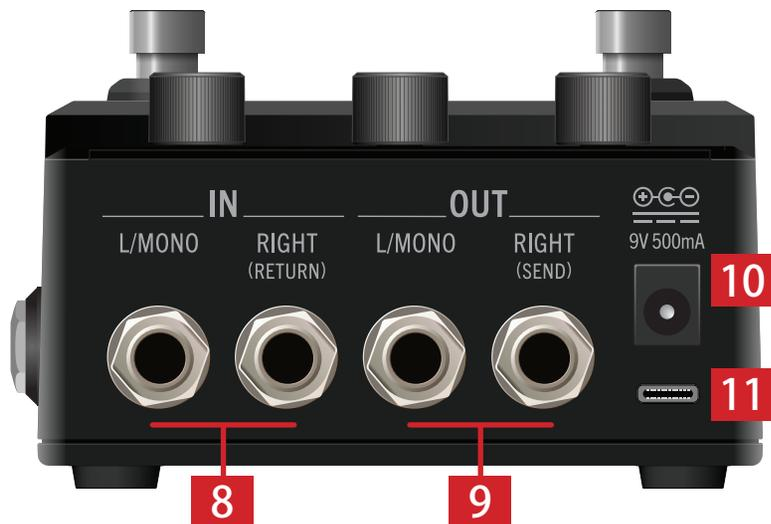
**注記:** デフォルトでは、HX Oneは、ステレオまたはモノラルに設定されています。両方のINまたはOUT端子にケーブルを接続するとステレオに、INまたはOUT L/MONO端子のみに接続するとモノラルになります。また、「[設定ビュー](#)」-「I/O Config」オプションを「Insert」に設定すると、OUT RIGHTとIN RIGHT端子がモノラル・エフェクト・ループのSENDとRETURN端子として機能します。[7ページ](#)、「[セットアップ例](#)」も参照してください。
